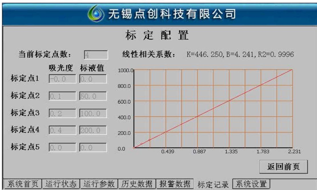
说明：本页面显示当前仪器内部的标定情况，包含标定点数，详细的标定点，线性相关系数等等。坐标值的显示量程由当前的系统内部量程决定。
