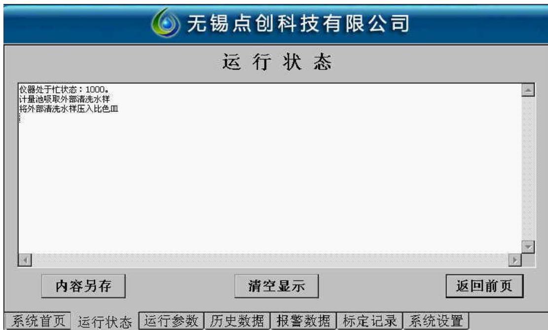
说明：该页面为显示系统做样状态过程的文字记录，用于直观的显示当前设备的做样动作及做样过程中的故障判断。三个按钮的作用如下：
