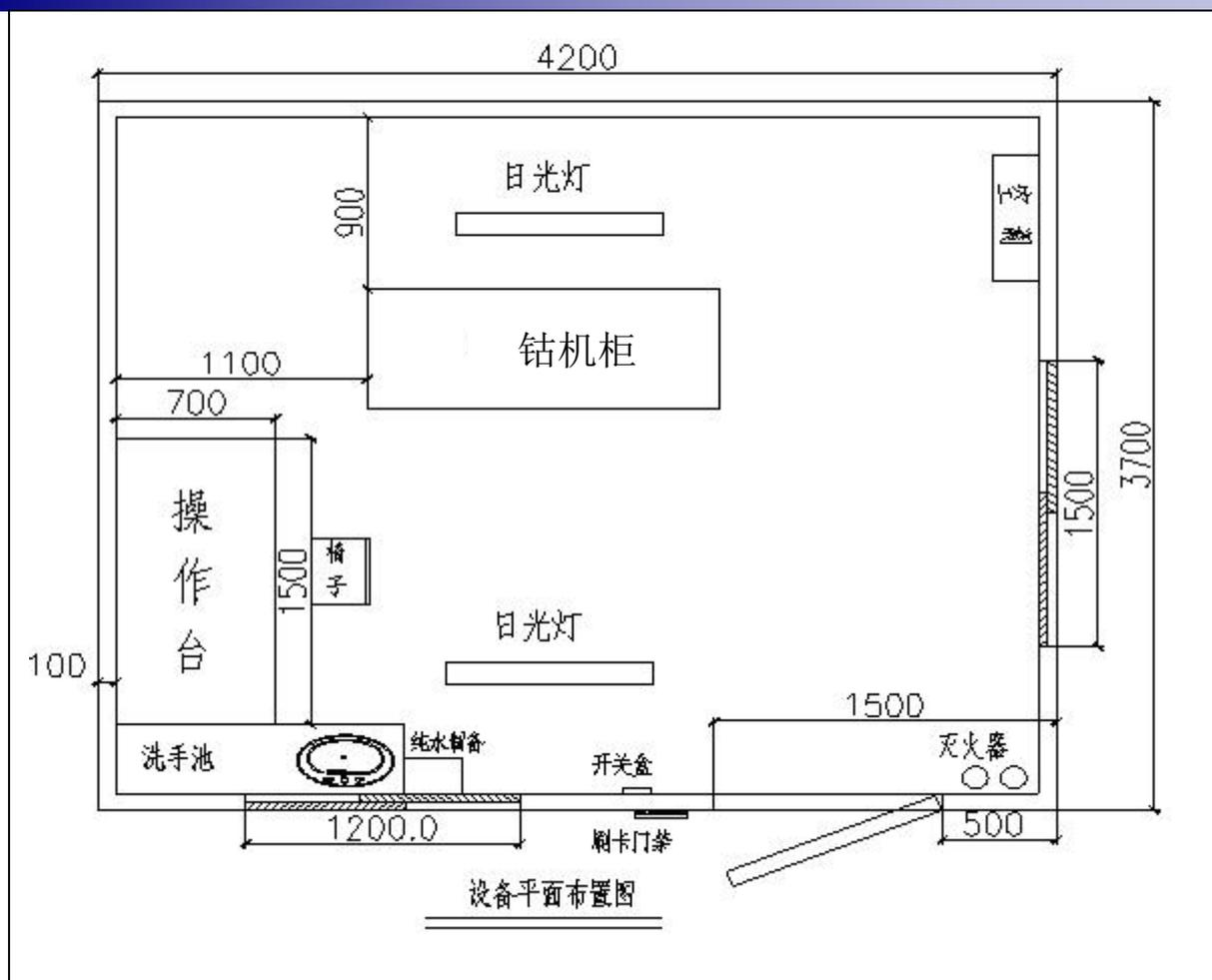
图 4.3 工作站安装（建议）平面示意图
