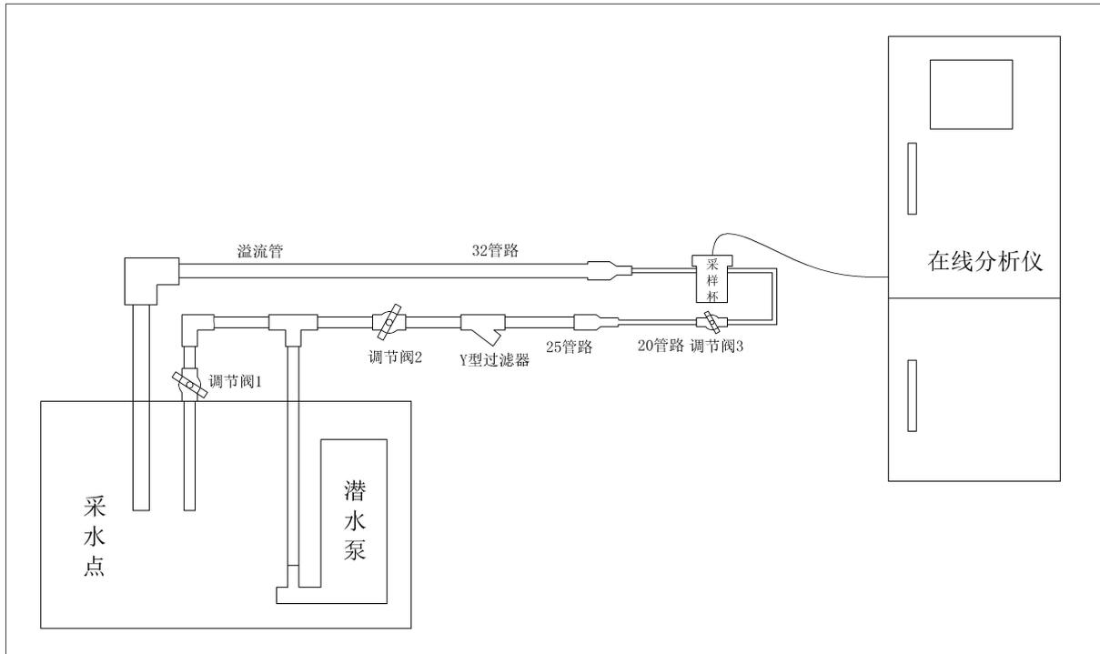
安装时，潜水泵需用不锈钢过滤网将泵体包住，将水泵一半潜入水下，但不能直接放置在水底，水泵采用悬挂式固定，采用 80 目以上不锈钢 Y 型过滤器与管路连接至仪器附近，同时在 Y 型过滤器前后安装两个调节阀。采样杯安装保证水平高度不高于仪器采样管出口，溢流管路保证不得有一处水平高度高于采样杯高度，采样杯溢流管管路不超过 1 米，变径为  $\Phi 32$  管路链接至采水点回流。
